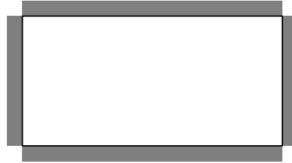
Einfeldplatte auf allen Rändern gelagert
